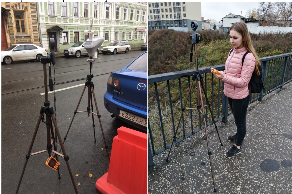
Рис.1. Выполнение измерений метеорологических параметров с помощью wi-fi метеостанции (слева) и с помощью анемометра (слева и справа)
